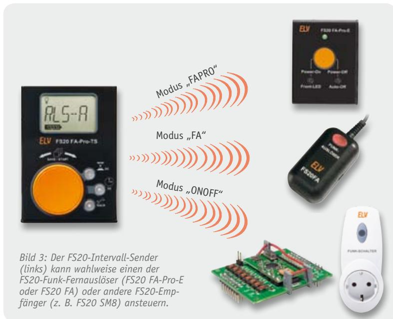
Bild 3: Der FS20-Intervall-Sender (links) kann wahlweise einen der FS20-Funk-Fernauslöser (FS20 FA-Pro-E oder FS20 FA) oder andere FS20-Empfänger (z. B. FS20 SM8) ansteuern.
