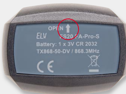
Bild 20: Innen in der rückseitigen Gehäusehälfte (links im Bild) befindet sich ein Pfeil, der in dieselbe Richtung zu weisen hat wie der Pfeil auf dem grauen Typenschild (rechts im Bild). Das Typenschild ist also richtig herum einzukleben.
