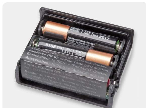
Bild 16: Die fertig aufgeklebte Elektronikabdeckung, die zugleich als Kurzanleitung dient
