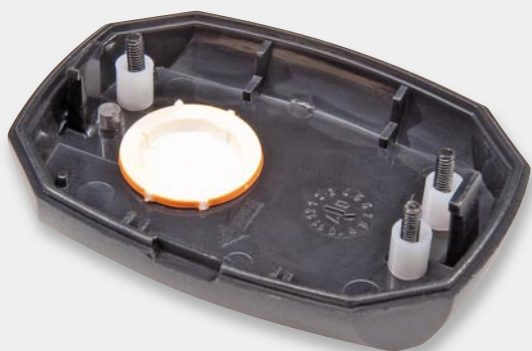
Bild 17: Das Oberteil des Sendergehäuses mit den drei Schrauben, drei Abstandsrollchen und der Tastkappe
