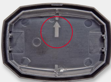
Bild 20: Innen in der rückseitigen Gehäusehälfte (links im Bild) befindet sich ein Pfeil, der in dieselbe Richtung zu weisen hat wie der Pfeil auf dem grauen Typenschild (rechts im Bild). Das Typenschild ist also richtig herum einzukleben.
