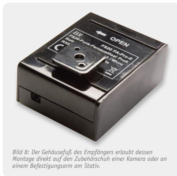
Bild 8: Der Gehäusefuß des Empfängers erlaubt dessen Montage direkt auf den Zubehörschuh einer Kamera oder an einem Befestigungsarm am Stativ.
