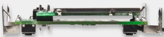
Bild 7: Das Transceiver-Modul liegt auf der ganzen Länge genau parallel zur Platine.
