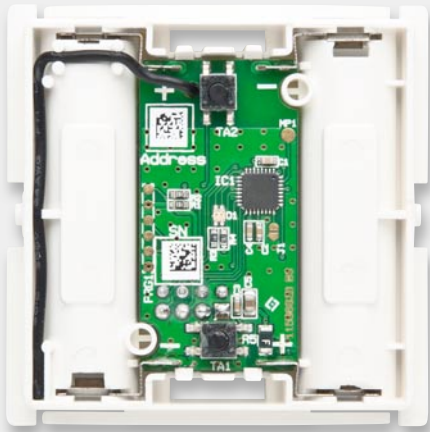
Bild 10: Die in das Gehäuse eingesetzte Platine
