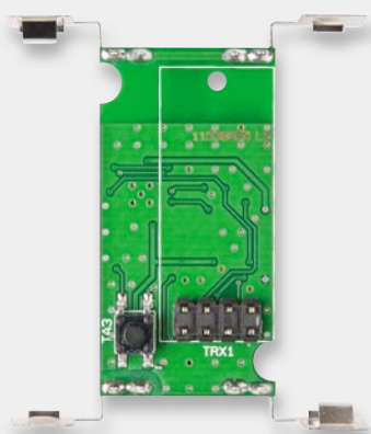
Bild 6: Die Platine mit bestückter Stiftleiste
