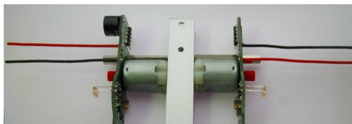
Nun werden die Kabel durch die Löcher nach innen geführt und an die Motoren angelötet (siehe Abbildung). Dazu müssen die Kabel passend gekürzt und abisoliert werden.
