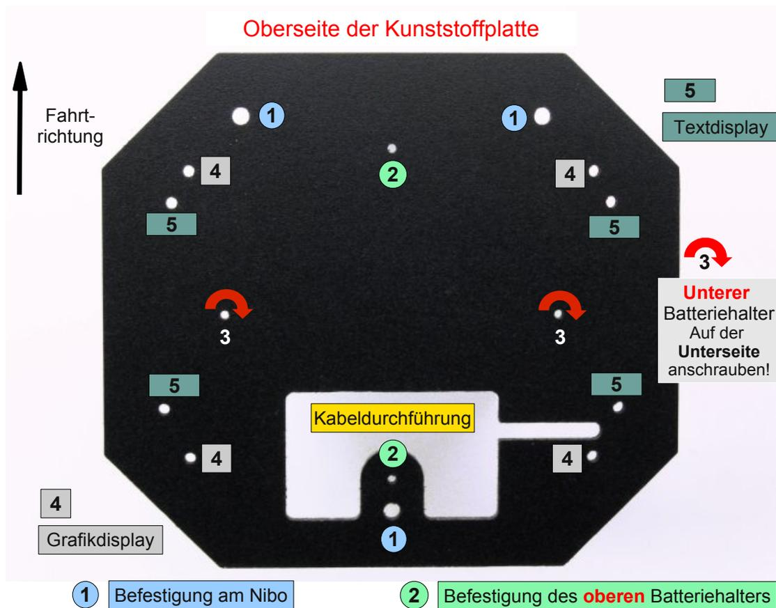
Die komplette zweite Etage wird jetzt mit drei Innensechskantschrauben durch die Bohrungen (1) auf den Abstandsbolzen der Antriebssektion festgeschraubt. Vorher sollte man jedoch den **Roboter ausschalten** (Kippschalter nach hinten), alle Stecker in die vorgesehenen Buchsen stecken und die Kabel optimal platzieren.
