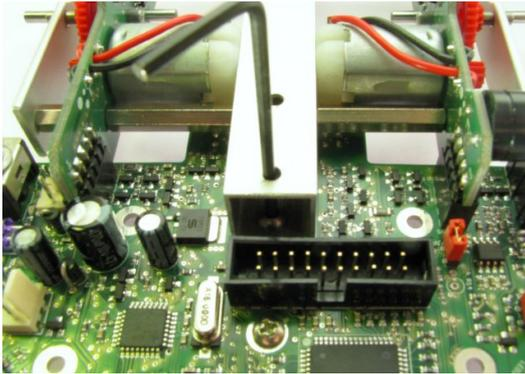
mit einer Pinzette zwei Innensechskantschrauben von innen durch die zwei vorderen Bohrungen des Vierkantprofils. Nun wird die Antriebssektion mittels der Pfostenstecker der OMS-Platinen an der Hauptplatine befestigt. Achten Sie dabei darauf, dass die beiden zuvor eingeführten Schrauben mit durch die Platine geführt werden. Diese beiden Schrauben werden nun von unten mit jeweils einer Kunststoff-
