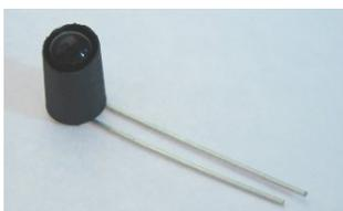
Außerdem werden die Phototransistoren durch 8 mm lange Schrumpfschlauchstücke abgeschirmt. Dafür müssen die Schrumpfschlauchstücke ca. 1 mm nach unten über den Boden der Phototransistoren hinausragen und mit Hitze (am besten mit Heissluft, notfalls mit dem LötKolben, dabei aber mindestens
