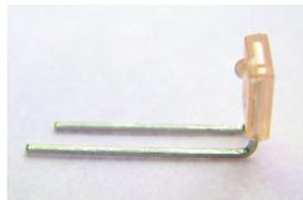
Die beiden IR-LEDs (IRL80A) **PE6** und **PE7** werden zunächst mit einer Zange so umgebogen, dass die Linse in Richtung der abgewinkelten Beinchen zeigt. Das Stück vom Plastikkörper bis zur Biegung muss
