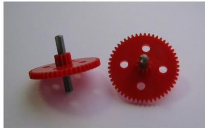
Nun werden die beiden weißen Zahnräder auf die beiden langen Stahlachsen (3x37 mm) aufgepresst. Der Abstand vom kleinen Zahnrad bis zum Achsende muss dabei 17 mm betragen:
