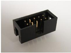
Die drei Wannenstecker **X4**, **X5** und **X6** müssen in der richtigen **Orientierung** auf die Platine gelötet werden. Die Aussparungen an den Wannen sind auf dem Bestückungsdruck sichtbar.
