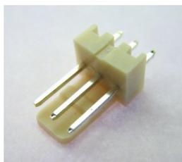
Der 3-polige Stecker für die Stromversorgung **X7** und die beiden 2-poligen Batteriepackstecker **X1** und **X2** müssen unter Beachtung der korrekten **Orientierung** eingelötet werden. Die Nase der Stecker ist auf dem Bestückungsaufdruck erkennbar.
