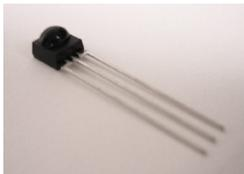
Beim Einbau des Infrarot Empfangs-ICs **U5** muss die korrekte **Orientierung** beachtet werden: die Halbkugel muss nach außen (zum Platinenrand hin) zeigen!
