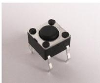
Der Einbau der Taster **S2** (Resettaster) und **S3** (Funktionstaster) ist verpolungssicher. Er muss mit leichtem Druck bis zum Einrasten bestückt werden. Da das Pinout **nicht** quadratisch ist, sind
