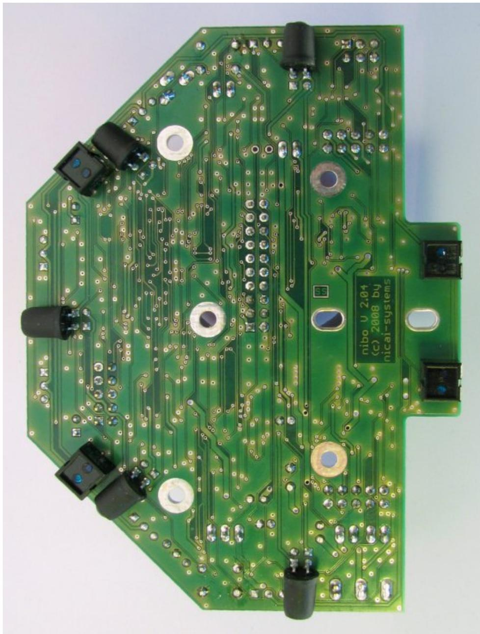
Die **Reihenfolge der Bestückung** richtet sich nach der Höhe der Bauteile, damit alle Lötstellen gut zugänglich sind. Die folgenden Unterabschnitte sind nach diesem Kriterium sortiert.
