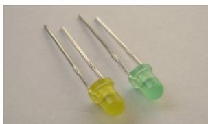
Die LEDs **LED1 - LED4** haben zwei Beinchen, ein kurzes (Kathode) und ein langes (Anode). Beim Einlöten muss die **Polarität** beachtet werden: Das **kurze** Beinchen muss jeweils in das **rechteckige** Lötpad.
