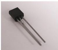
Die zwei PNP-Bipolar-Transistoren **T1** und **T2** sind vom Typ BC327. Bei der Bestückung ist darauf zu achten, dass die abgeflachte Seite der Transistoren in die gleiche **Orientierung** zeigt, wie auf der Platine angegeben ist.
