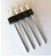
Die 4-polige Stiftleiste **X1** wird mit den langen Pinnen von oben in die vier **vorderen** (in Fahrtrichtung) Lötungen **X1** der **BGX1-Platine** gesteckt und von der **Unterseite** der Platine fest gelötet.
