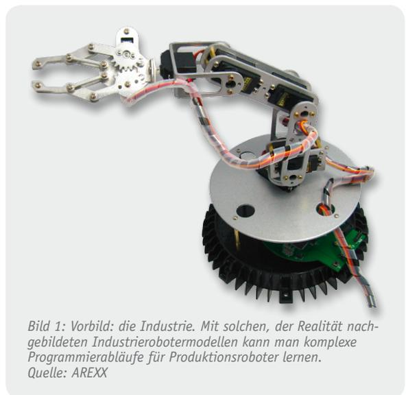
Bild 1: Vorbild: die Industrie. Mit solchen, der Realität nachgebildeten Industrierobotermodellen kann man komplexe Programmierabläufe für Produktionsroboter lernen.
