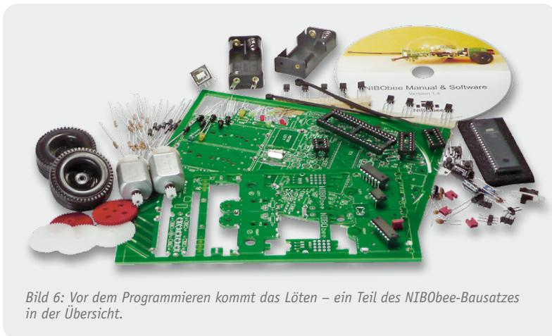
Bild 6: Vor dem Programmieren kommt das Löten – ein Teil des NIBObee-Bausatzes in der Übersicht.
