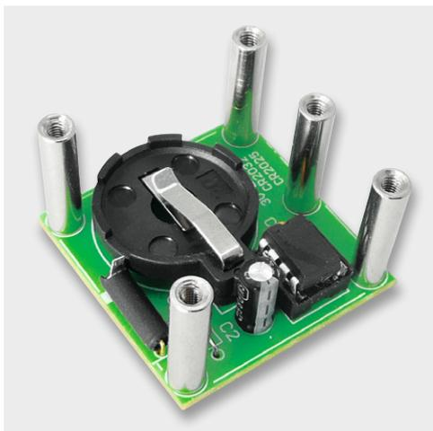
Bild 5: Die mit den Abstandshaltern versehene Prozessor-Platine
