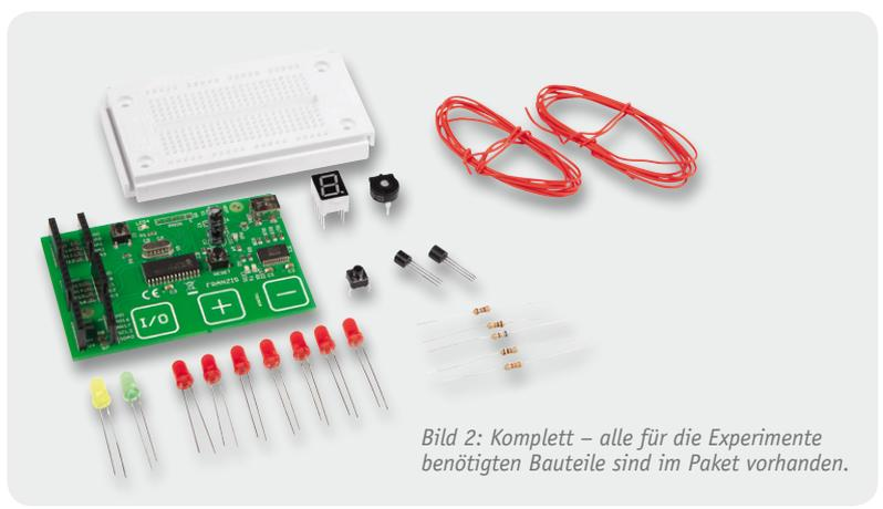
Bild 2: Komplett – alle für die Experimente benötigten Bauteile sind im Paket vorhanden.
