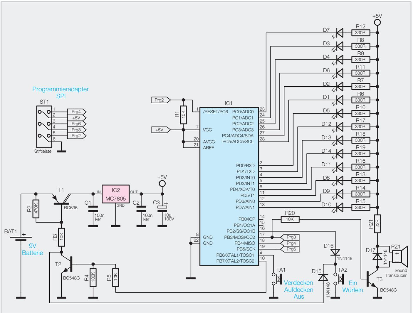
**Bild 1:** Die Schaltung des Würfelspiels, minimalistisch dank Mikrocontroller
