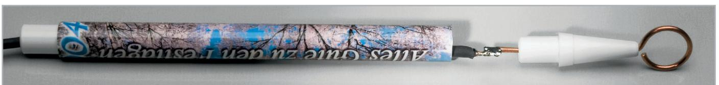
Bild 6: Der Einbau des Verbindungskabels und der Anschluss an die Drahtschleife
