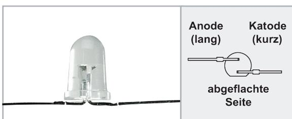
Bild 4: Im ersten Schritt werden die LED-Anschlüsse um 90 Grad abgebogen.
