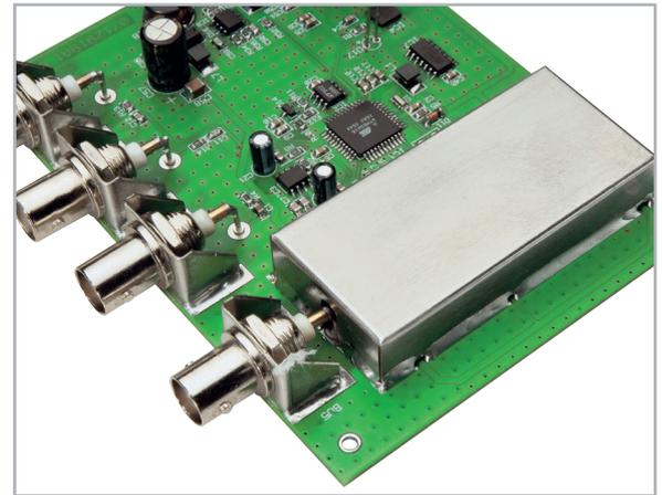
Bild 15: Die Montage und das Verlöten des Abschirmgehäuses
