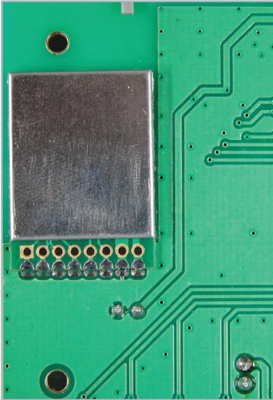
**Bild 5:** Die Montage des Transceivermoduls auf der Platinenunterseite
