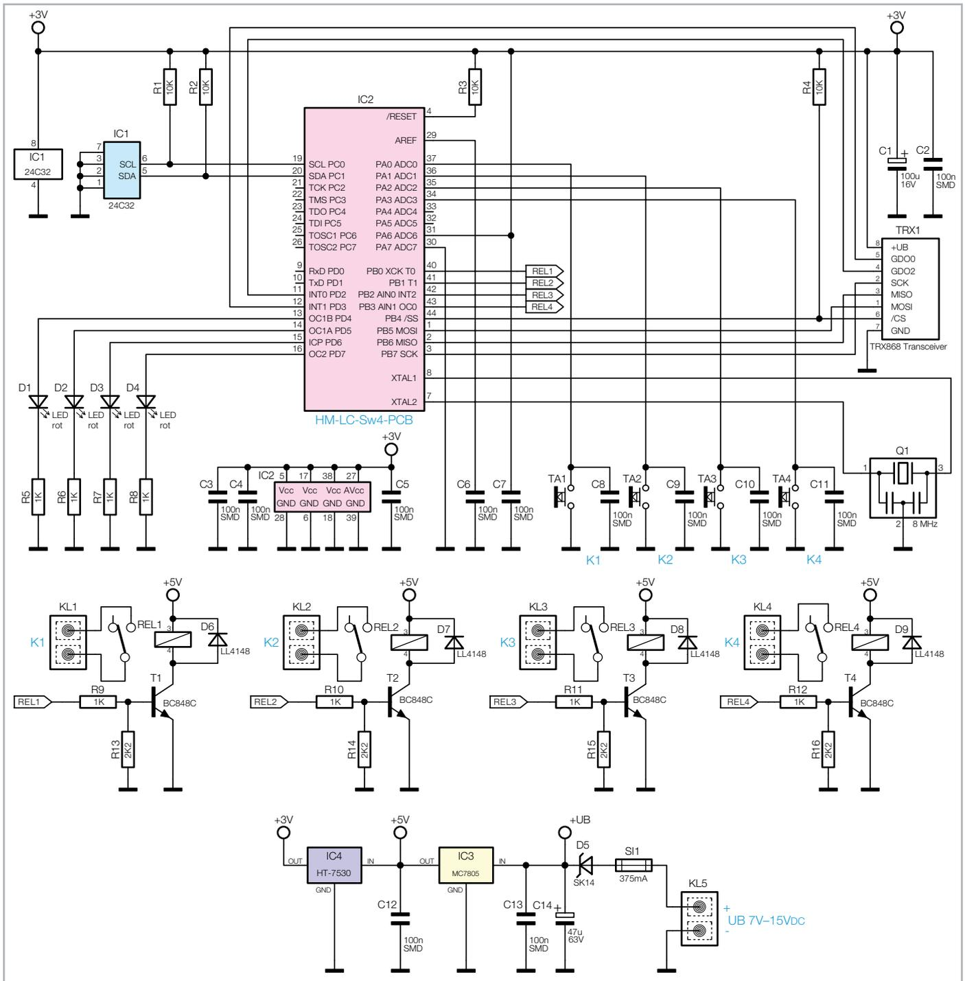
Bild 3: Das Schaltbild des 4-Kanal-Empfängers
