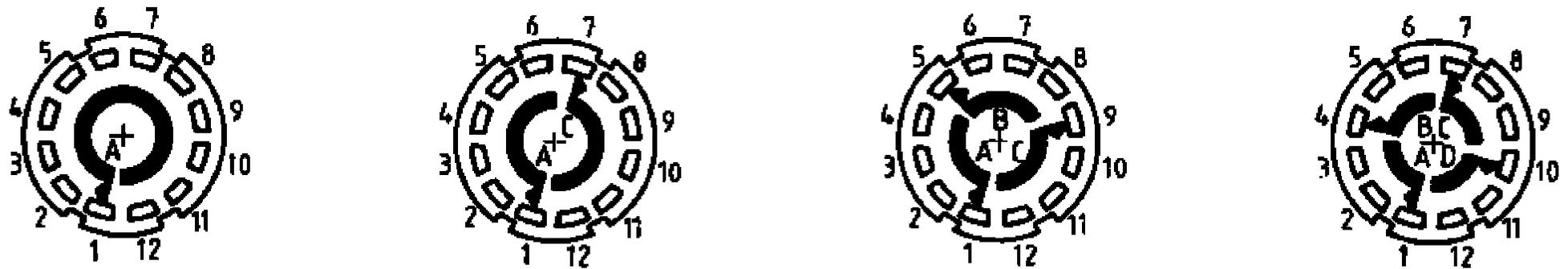
DS1\_: 1 x 12 Kontakte; DS2\_: 2 x 6 Kontakte; DS3\_: 3 x 4 Kontakte; DS4\_: 4 x 3 Kontakte
