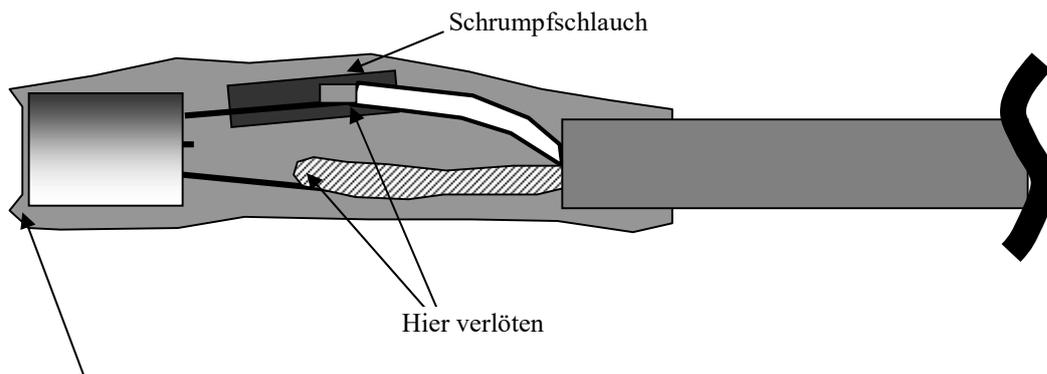
Am Ende muss der Schrumpfschlauch, der den gesamten Sensor isoliert gerade über den Sensor hinausragen.
