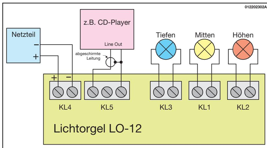
**Bild 2: Anschlussschema der Lichtorgel LO 12. Als Signalquelle dient in diesem Beispiel ein CD-Player.**
